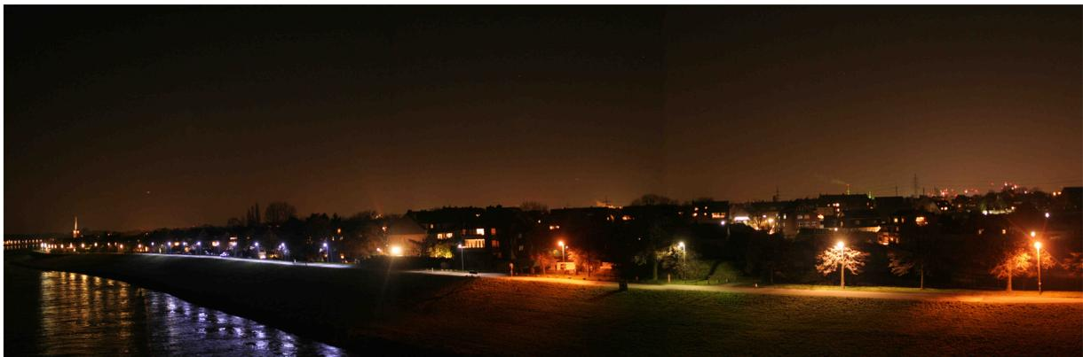
Bild 8: Fußwegbeleuchtung mit Lichtquellen unterschiedlicher Farben in Düsseldorf (ganz links Gasleuchten, blau: kaltweiße LED, warmweiße LED, gelb: Natriumhochdruckdampflampe, grün: Quecksilberdampflampe; hellgelb: Halogenmetaldampflampe)
